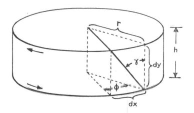
FOR TORSIONAL STRAIN  $\emptyset$ ,  $TAN \ \emptyset = \frac{dx}{dy} \ ,$
